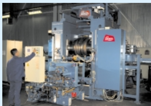
Harmonisches Duett. Die LASCO-Querkeilwalze QKW liefert zusammen mit der nachgeschalteten Plättstation PLV optimale Umformteile.
