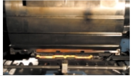
Richtiger „Dreh“. Die Querkeilwalze ist eine Anlage für die Materialvorverteilung von Rohlingen. Ein auf Schmiedetemperatur erwärmtes Walzgut wird dem Aggregat automatisch zugeführt (links), durch Führungsliniale exakt zwischen den Walzen positioniert (Mitte) und von diesen zu einem Rohling vorgeformt (rechts).
