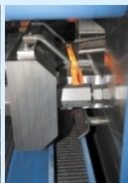
Plätten. Direkt nach dem Walzen werden die Rohlinge in der Plättstation geplättet (links) und anschließend über ein Transportsystem ausgetragen.
