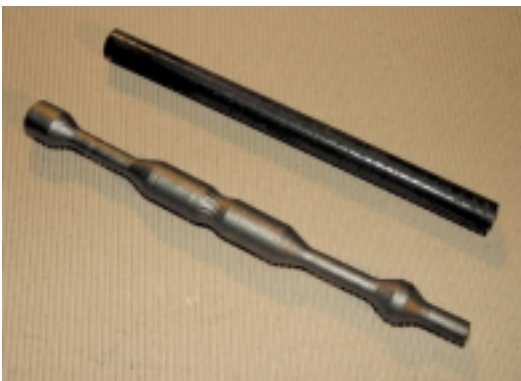
Querkeilwalzen. Das Material des Rohlings (oben) wird von der Querkeilwalze gestreckt und optimal verteilt.
