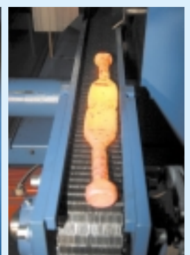
Plätten. Direkt nach dem Walzen werden die Rohlinge in der Plättstation geplättet (links) und anschließend über ein Transportsystem ausgetragen.
